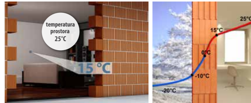
PROSTOR BEZ UGRAĐENE TOPLINSKE IZOLACIJE
