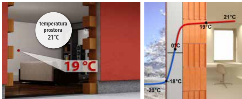
PROSTOR SA UGRAĐENOM TOPLINSKOM IZOLACIJOM
